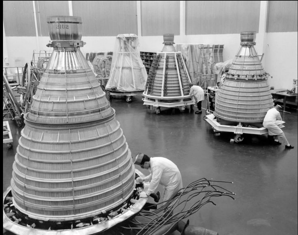
Assemblage de moteurs F-1 dans l'usine Rocketdyne, circa 1965 (crédits Rocketdyne)
