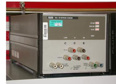
Tension de sortie : 1 V ; 1.018 V ; 10 V
