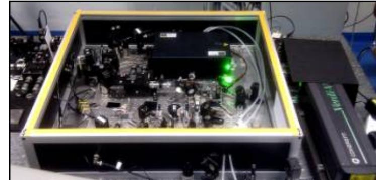
Peigne de fréquence constitué de raies spectrales dont l'écart est asservi sur l'étalon primaire de fréquence
