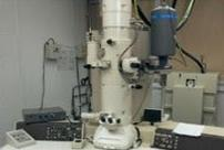
Microscope électronique à transmission (MET)
